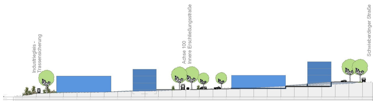
Systemschnitt / hellgrau: vorhandenes Gelände; dunkelgrau: Auffüllungen
