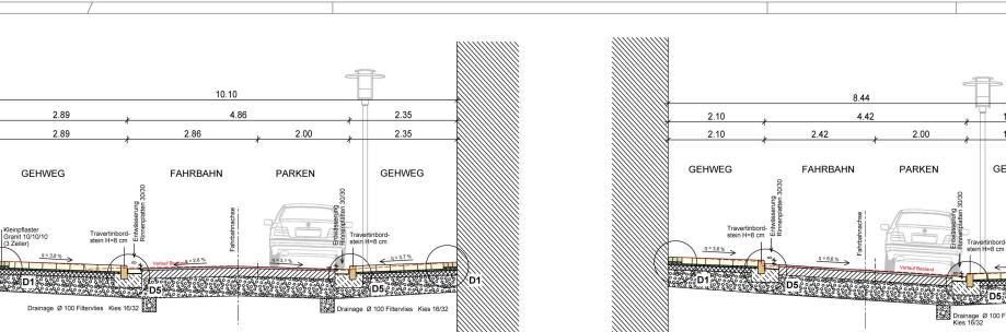
65 cm Aufbau Gehweg Fugenfüllung: 1. Füllung reiner Splitt 1 - 5 mm 66% 1 - 3 mm 33% 2 - 5 mm
