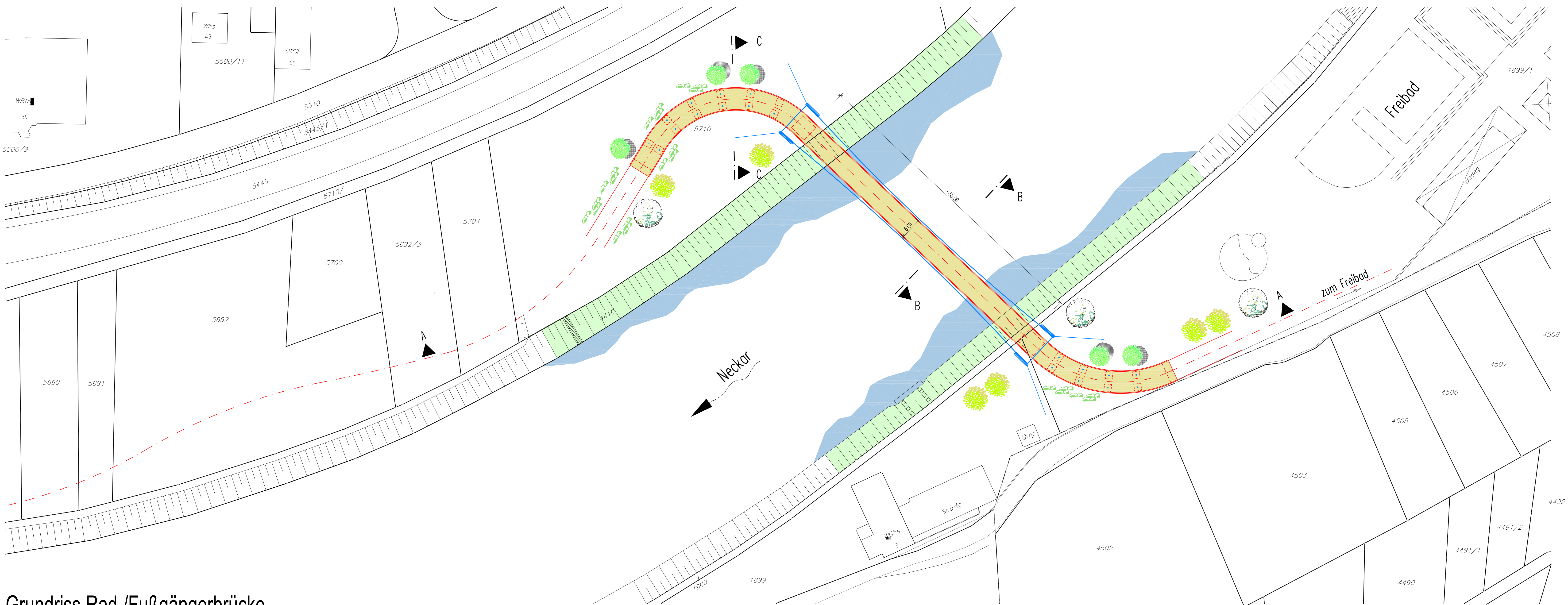
Grundriss Rad-/Fußgängerbrücke M 1:500
