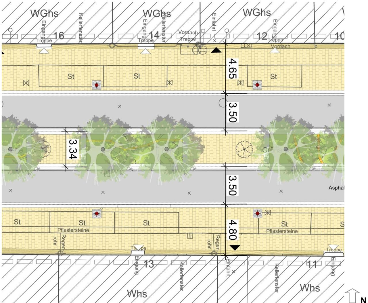
Abbildung: **Gestaltungsprinzip** (graue Linien bilden den Bestand ab)
