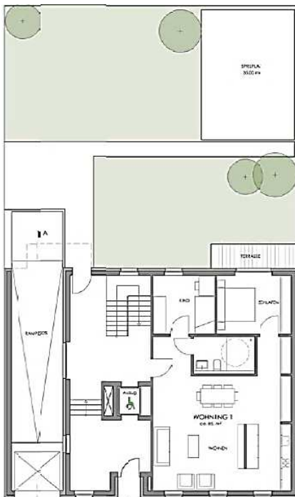
Grundriss Erdgeschoss mit Garten (Deckel TG)
