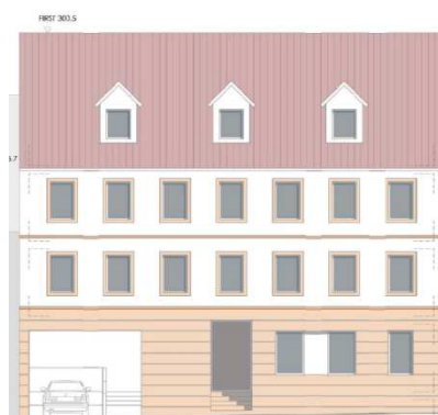
Ansicht von Schorndorfer Straße mit Giebelgauben (V2)
