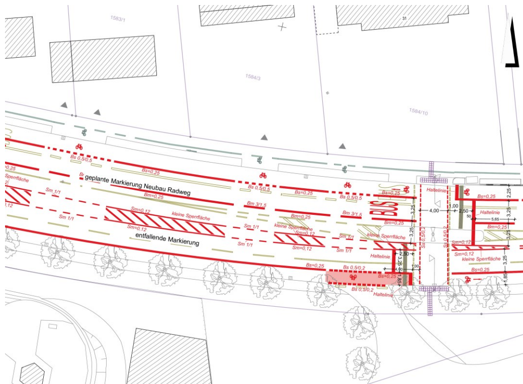
Abbildung 1: Ummarkierung der Fahrbahn im Bereich Marbacher Straße
