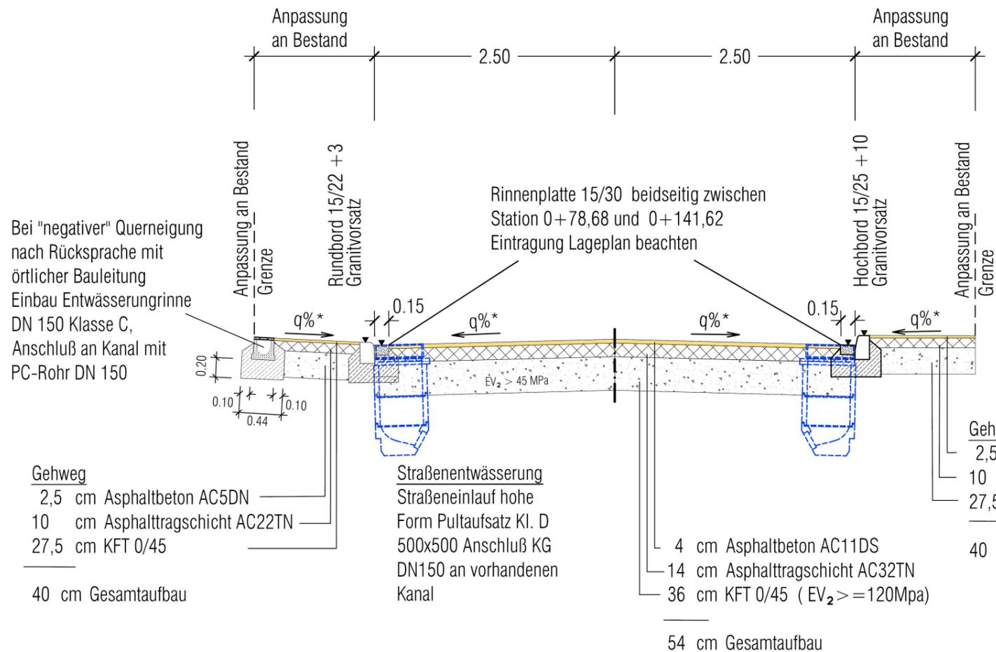
Bei "negativer" Querneigung nach Rücksprache mit örtlicher Bauleitung Einbau Entwässerungsrinne DN 150 Klasse C, Anschluß an Kanal mit PC-Rohr DN 150
