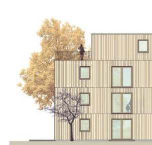
mit Staffelgeschoss und Dachbalkonen
