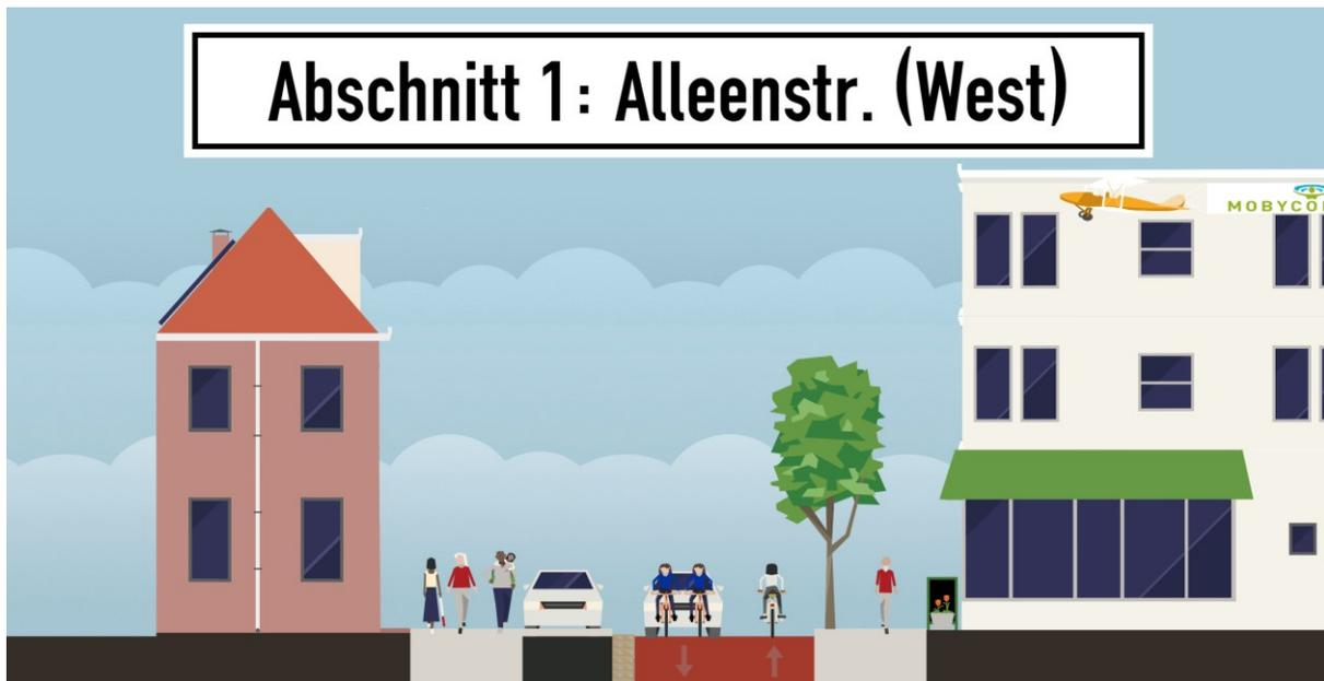
Systemquerschnitt Abschnitt 1: Fahrradachse, Kfz frei (Blickrichtung West)
