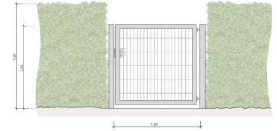
Ansicht - Stahlzaun mit Drahtgitterfüllung
