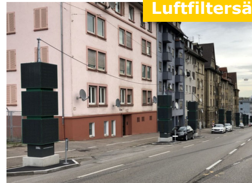
Luftfiltersäulen in Heilbronn
