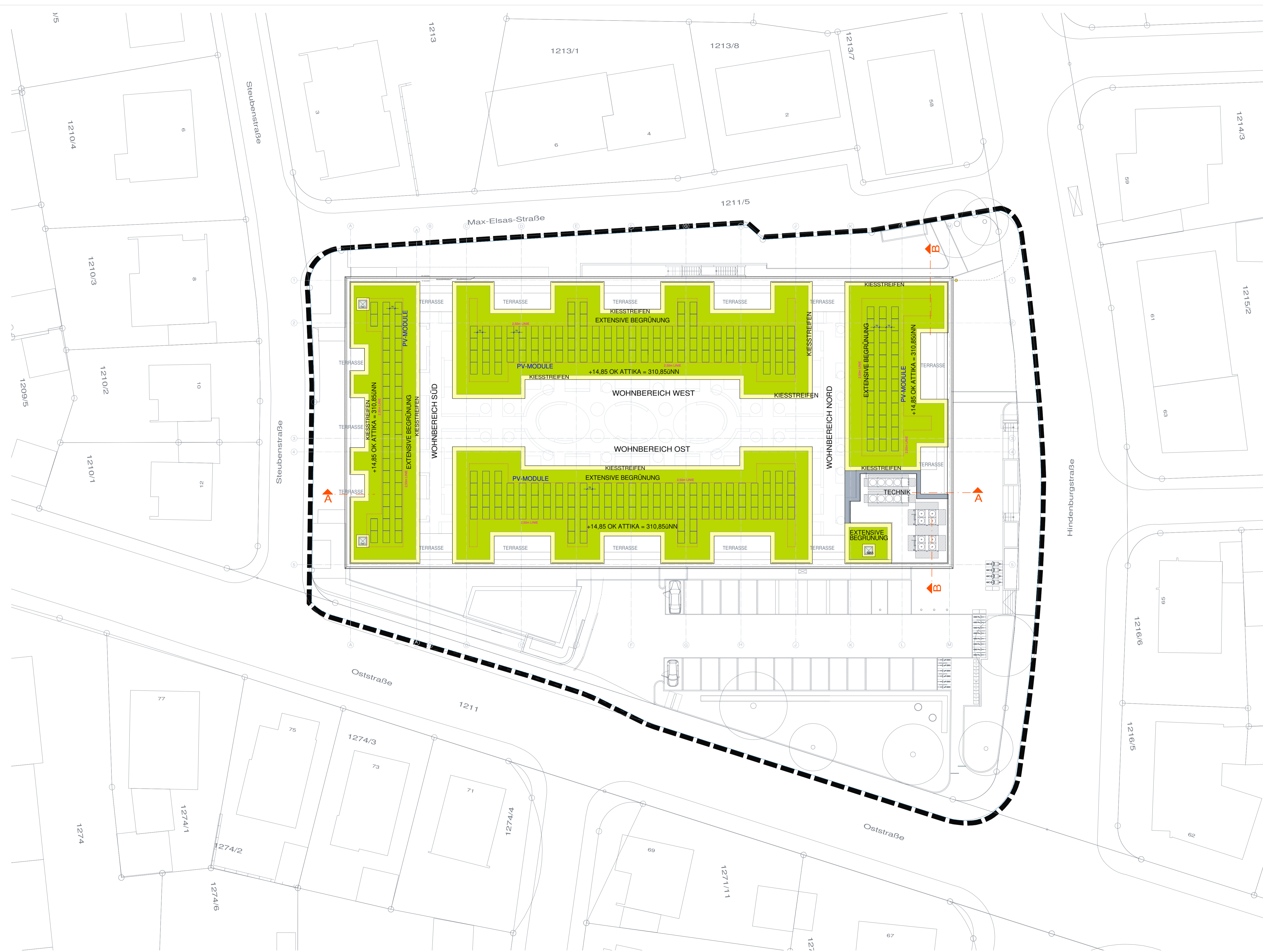
DA DACHDRAUFSICHT - 4 WOHNBEREICHE INKL. PV-ANLAGEN - +14,85 OK ATTIKA = 310,85ÜNN DIE FREIFLÄCHENGESTALTUNG IM INNENHOF DES WOHNESCHOSSES IST UNVERBINDLICH UND WIRD IM DURCHFÜHRUNGSVERTRAG ABSCHLIESSEND GEREGLT.
