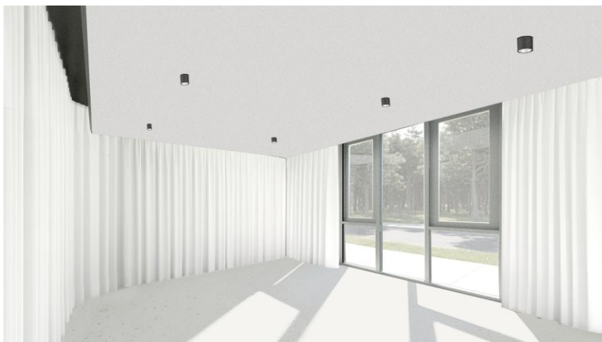
Akustikdecke und textile Vorhänge
