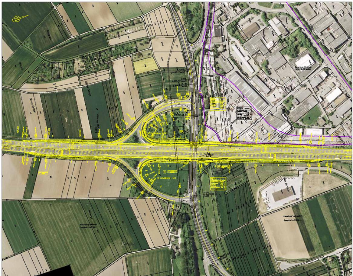
Die Variante 1 stellt den Umbau der AS Ludwigsburg Süd durch die Erweiterung des vorhandenen Überführungsbauwerkes der A 81 über die L 1140 mit zwei Parallelbauwerken dar. Eine Verbreiterung des bestehenden Brückenbauwerkes ist aufgrund der vorhandenen Längs - und Quervorspannung nicht möglich.
